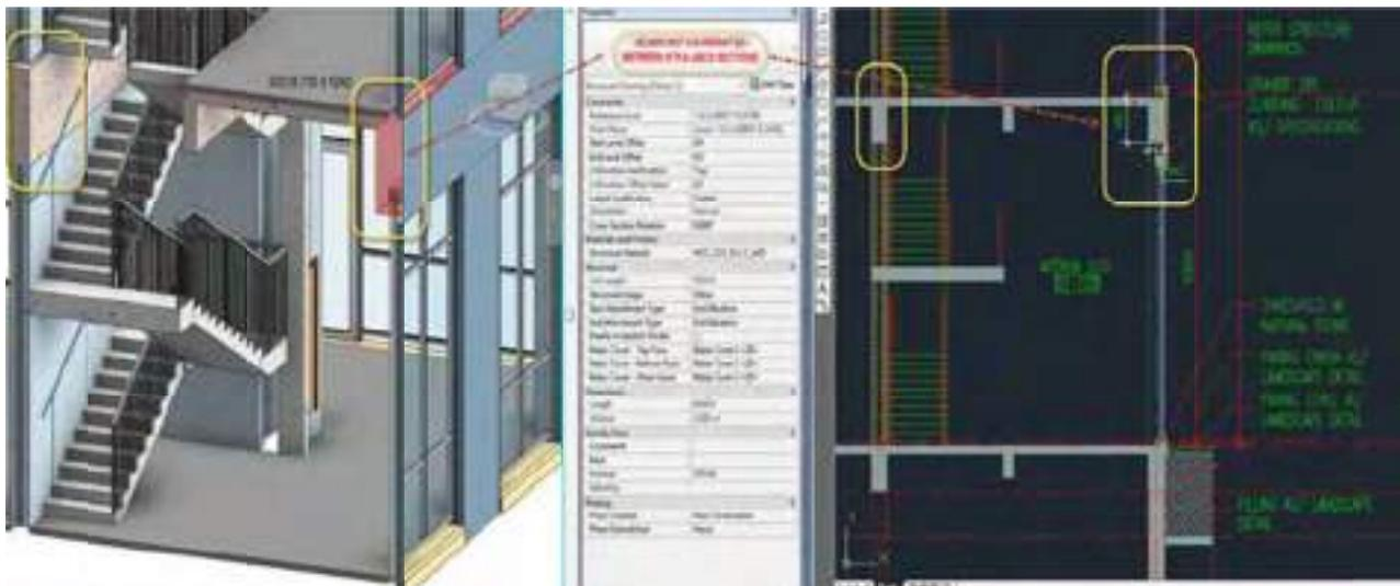
relativa a un progetto edilizio. Utilizzando il modello architettonico, l'ingegnere strutturale sviluppa un layout strutturale generale dell'edificio. Da qui parte lo sviluppo di un modello strutturale preliminare. Esso è poi condiviso con l'architetto per la conduzione di un esercizio preliminare di coordinamento con il modello architettonico.
