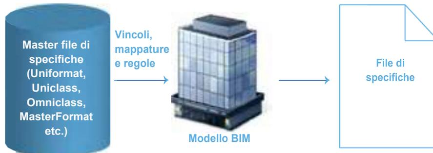
di costruzione. In questa fase del progetto si aggiungono delle specifiche al modello utilizzando un formato aperto e interoperabile. L'obiettivo consiste nello stabilire un protocollo per l'identificazione di proprietà richieste per specificare materiali, prodotti e impianti utilizzati nel modello.
